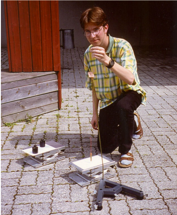
Abb. 8 Mit dem Lot wird der Fußpunkt ermittelt. (Dies führten wir natürlich zu zweit durch, es fehlte jedoch eine dritte Person zum Fotografieren)
