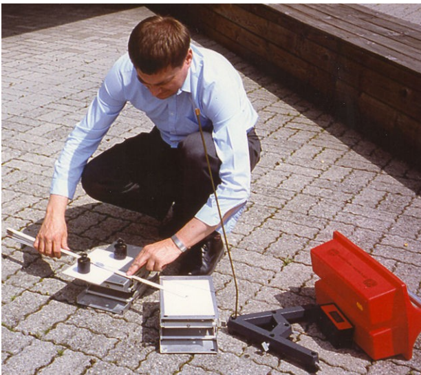
Abb. 11 Die Bestimmung der Schattenlänge (Auch diese Messungen führten wir zu zweit durch)
